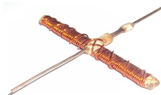
Figura 2. Rotor y Conmutador
